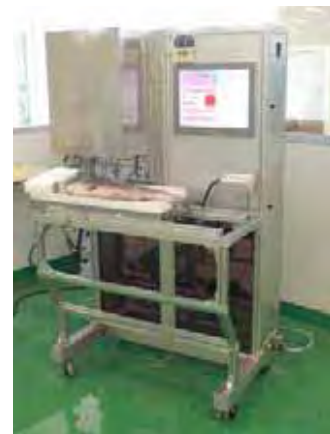
図2. 秋サケの身色等級判別装置（試作機）
