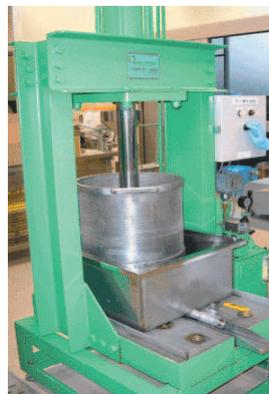
油搾汁機に圧による脱水
