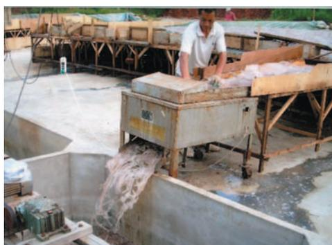
中国国内では、これまでもエチゼンクラゲが加工原料として用いられてきたが、いわゆる「塩クラゲ」製品は、傘部断片の形状を保持したまま時間をかけて塩とミョウバンで処理するタイプの製品（2回メ）が主流であった。近年になり、上の写真にみられるように、エチゼンクラゲの加工工程において、表面の汚れを取った後そのまま細切し、すぐにミョウバンと塩で1回だけ処理（1回メ）した生に近い製品が作られるようになってきた。この工程は5日ほどで製品ができるため、簡便かつ低コストであり、需要は急増している。中国国内の一般家庭や料理店に販売され、野菜炒め等の総菜の素材として用いられている。
