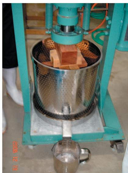
図2 油圧プレスによる脱水
