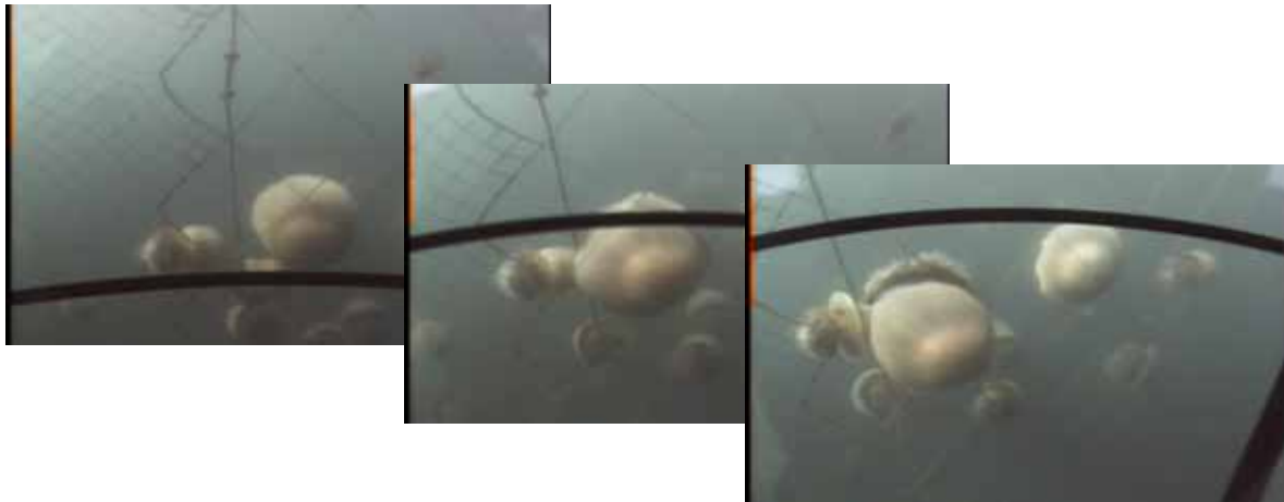
図3 大目網 (目合 1500mm) を通過する大型クラゲ 各写真の左側は従来の網 (目合 300mm)
