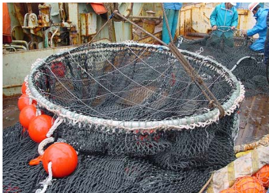
図4. テンレス製ワイヤーを張った円形枠
