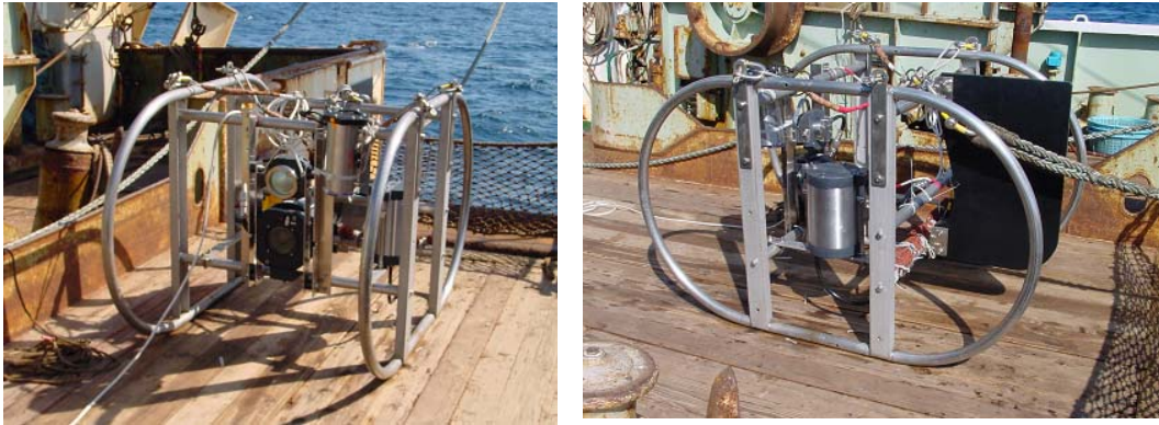
図5 水産工学研究所で新たに開発した光ファイバーケーブルを用いた水中ビデオカメラ（リアルタイムで観察できる）
