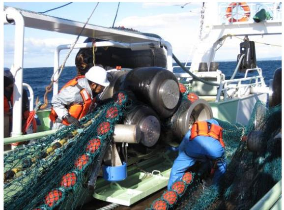
以上のことを解決するための方策として、片舷のみのVローラー本体を使用する方法を採用した。片舷利用のVローラー方式においては、揚網に掛る所要時間も従来方式と大きな違いはなく、両舷利用時において手間や労力が大きかったVローラー本体と網捌き機からの漁具の取り外しについても手作業で可能なため、より作業性が向上した。
