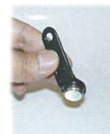
温度データロガー (KNラボラトリーズ製, サーモクロン) サンプリング間隔: 4分
