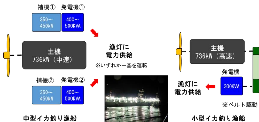
図 4-10 漁灯に供給する電力の発電方法
