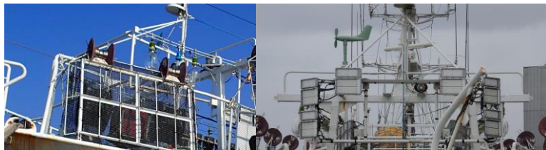
図 2-2 MH 漁灯と LED 漁灯の放射照度分布シミュレーション結果 (上段)と船首側パネル増設前後の LED 漁灯配置(下段, 左:増設前, 右:増設後)
