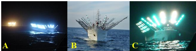
図 1-8 サンマ棒受網漁業の LED 漁灯 A: LED 漁灯(右)と白熱・MH 漁灯(左) 実装船 B: 船首から見た LED 漁灯全装漁船 C: 夜間操業中の LED 漁灯全装漁船 D: LED 漁灯下のサンマ(約 25t 漁獲)
