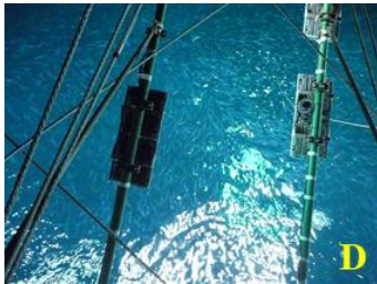
図 1-8 サンマ棒受網漁業の LED 漁灯
