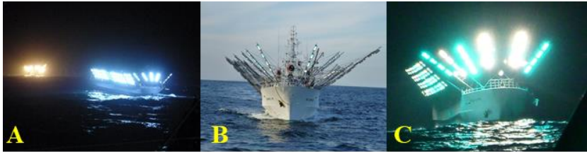
図 1-8 サンマ棒受網漁業の LED 漁灯
