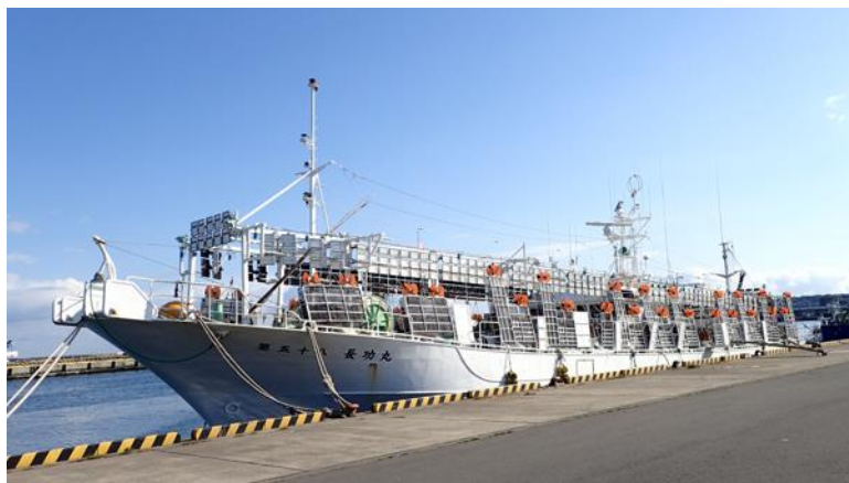
図 4-6 LED 漁灯を装備した中型イカ釣り漁船
