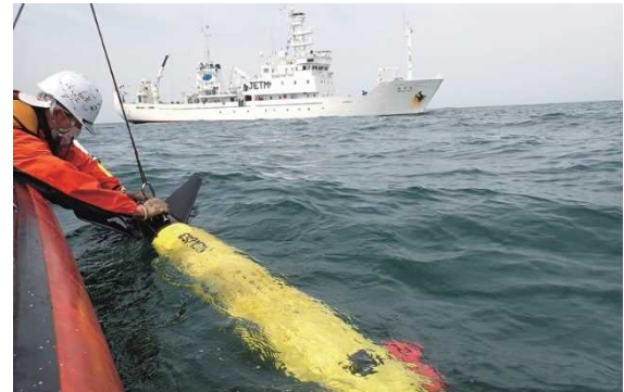
写真 長期運用した水中グライダーを回収 母船の漁業調査船からポートを降ろし、水中グライダー（全長約2メートル、重さ約60キロ）を回収するようす
