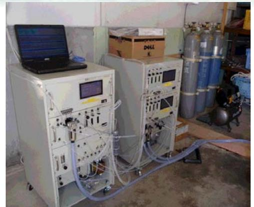
図1 二酸化炭素濃度調整装置（右：メインコントローラー、左奥：二酸化炭素ガスを海水に溶け込ませる吸収塔大小）と、様々な二酸化炭素濃度で調整した海水でエゾアワビ初期幼生を飼育する実験装置（左手前）。
