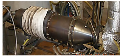
図5. 燃焼式再生器付DPFの写真
