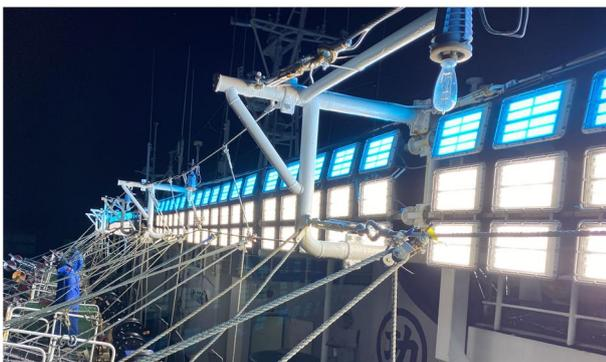
図1. 調査船に搭載したLED船上灯
