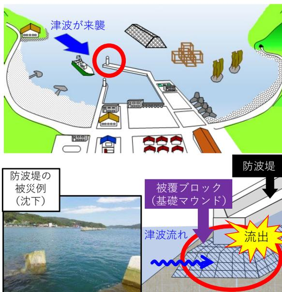
図1. 漁港、防波堤や被覆ブロック被災の模式図と風景(写真は水産総合研究センター 2012「震災復興に向けた活動報告集」より転載)
