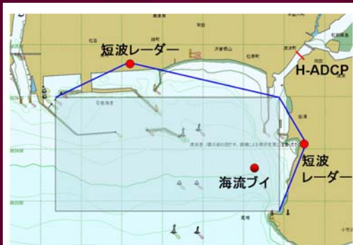
図2. カキを対象とした石巻湾の調査計画の概要。石巻浦からのカキ幼生の輸送量をH-ADCPで、石巻湾内での輸送パターンを短波レーダーで調査するとともに、採苗に重要な水温・海流情報をリアルタイムに提供するブイを設置する。
