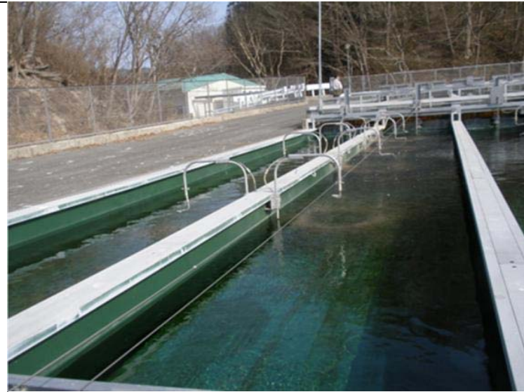
給餌は全て自動給餌機で実施 吐出部はSUS製に改良
