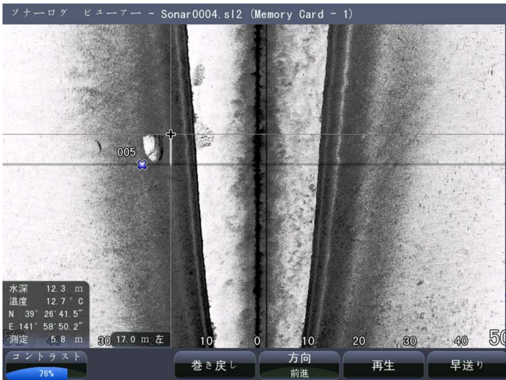
図 6-5 再生したサイドスキャン画像による物標の測定
