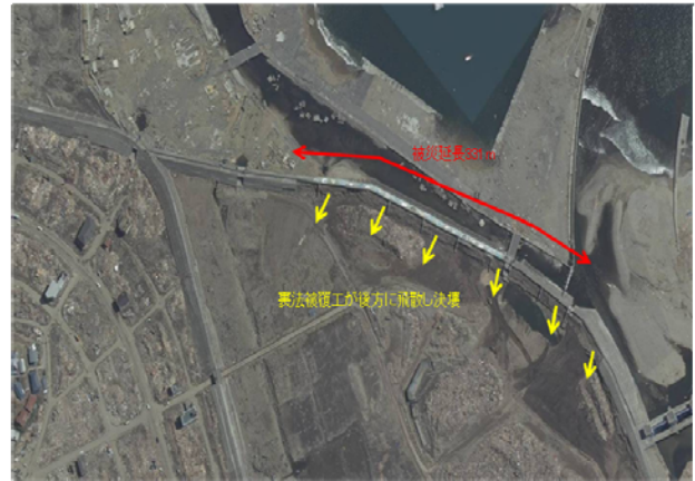
図-1.22 北防潮堤（第1線堤西側）の被災状況 (左図：被災直後(3/13)に撮影写真(岩手県提供))
