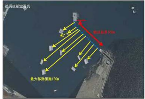
図-1.9 東防波堤（左図）、防波堤（右図）周辺の被災と堤体の移動状況
