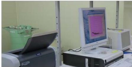
V-3容器を、ポリ袋に入れ密封し、検出部の上に中心を合わせて載せて、扉を閉め、測定を開始する。
