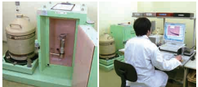
写真、ゲルマニウム半導体検出器(左)と測定のようす(右)
