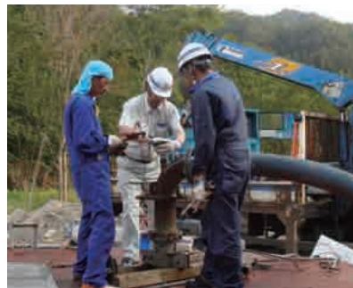
揚水量調査 (岩手県野田村の下安家ふ化場)
