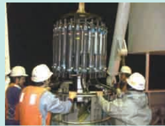
CTD ロゼットサンプラー 水温・塩分の測定と放射状にセットしたニスキン採水器により採水ができる
