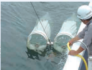
資源量の推定のために卵、仔稚魚の調査を行う (写真はボンゴネットで卵、仔稚魚を採取しているところ)
