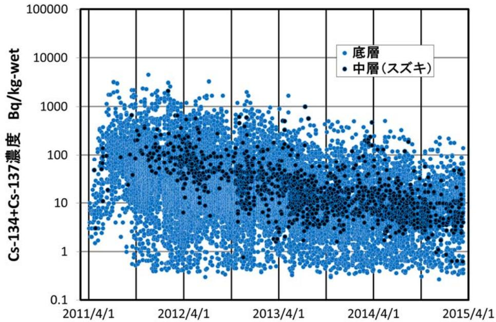
図 2. 水産庁公表データから抽出された東日本海域の底魚類・岩礁性魚類の Cs-134+Cs-137 濃度測定値の時間変化。水産庁公表データにおいて生息域が「底層」に分類されている魚類に「中層」に分類されているスズキを加えた魚種のデータを用いた。
