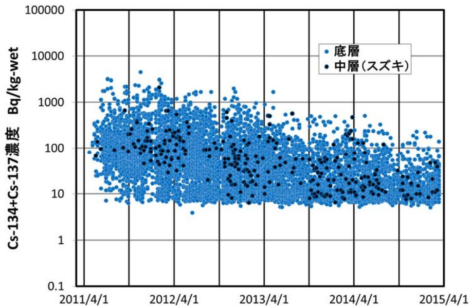
図 3. 水産庁公表データから抽出された福島県沖の底魚類・岩礁性魚類の Cs-134+Cs-137 濃度測定値の時間変化（福島県測定分）。水産庁公表データにおいて生息域が「底層」に分類されている魚類に「中層」に分類されているスズキを加えた魚種のデータを用いた。
