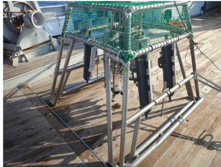
図1 ニスキン採水器を内側にとりつけたマルチプルコアラー採泥器
