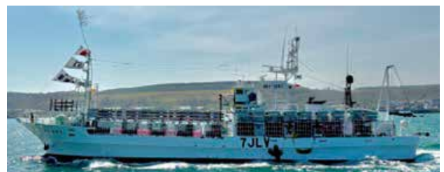
図3. アカイカ兼業船に改造した大型サンマ漁船
