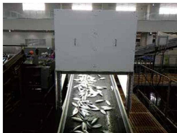
図2. 長崎県松浦魚市場のベルトコンベア上に設置した自動撮像装置
