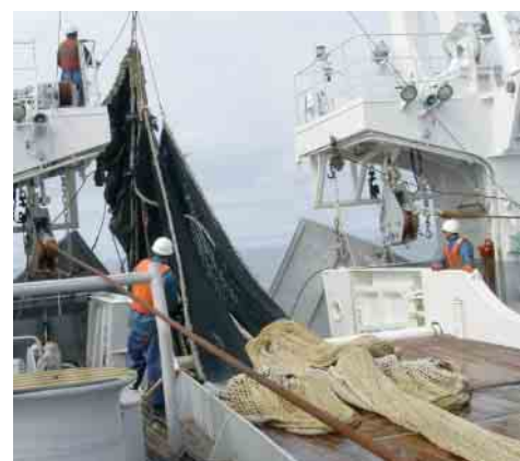
図4 開洋丸による夏季ベーリング海沖合調査 さけ・ます類を漁獲するための表層トロール網を船尾より投入しているところ。
