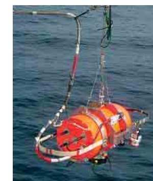
図7 海上実験中のJ-QUEST \chi 下側に突出しているのが500m耐圧型送受波器。
