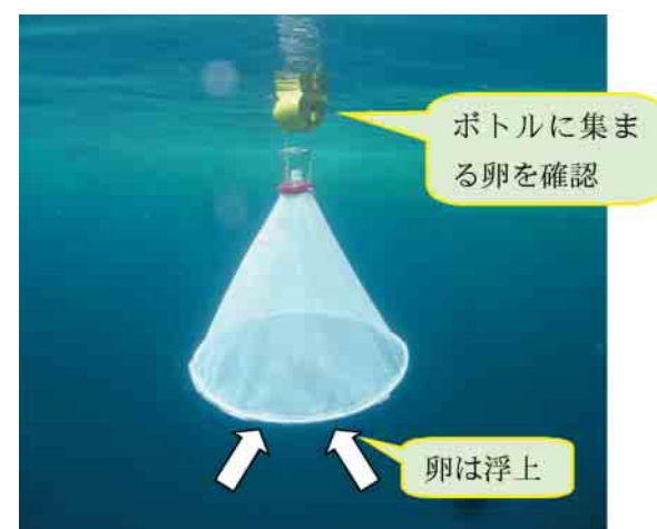
図5 産卵チェックネット 生み出された卵は浮上するので、下向きのアートネットに卵を集めて有無を確認する。
