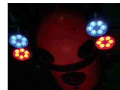
図8 赤、青のLED照明を点灯したJ-QUEST \chi 送受波器は未装着。
