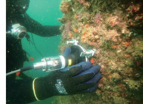
図3 磁気センサーによる測定状況
