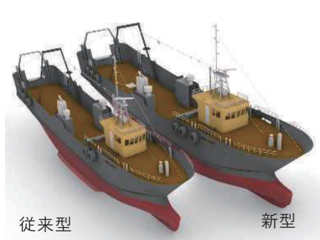
図1 従来型の漁船サイズ（左）と複合漁業に対応する新機能追加を考慮して大型化した漁船サイズ（右）
