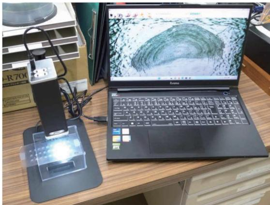
図1 顕微鏡カメラによる教師画像取得の様子
