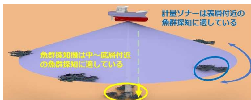
図1 計量ソナーと計量魚群探知機を併用した調査のイメージ。計量魚群探知機は下向きに音波を、計量ソナーは横向きに音波を送信する。
