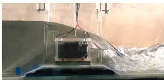
図1 構造物に作用する津波波力を把握するための水理模型実験(左側:防波堤、右側:防潮堤) (大村智宏・古市尚基・大井邦昭)
