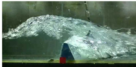
図1 構造物に作用する津波波力を把握するための水理模型実験(左側:防波堤、右側:防潮堤) (大村智宏・古市尚基・大井邦昭)
