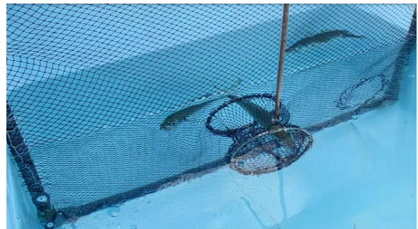
図2 魚が漁網を押し力の計測実験。
