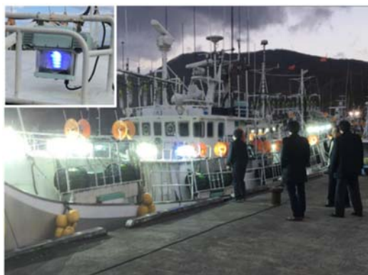
図 1 プラズマ漁灯(左上)と実証試験船
