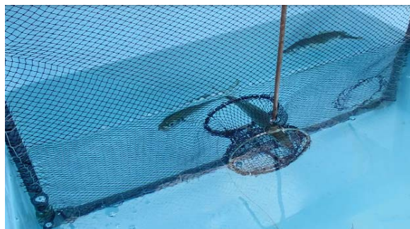
図2 魚が漁網を押しす力の計測実験。
