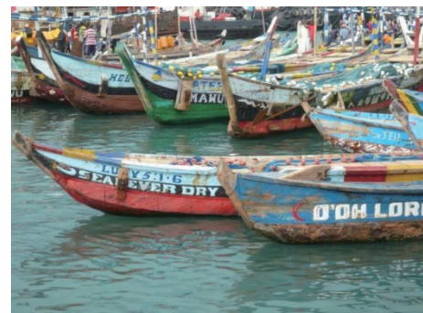
図2 現地で使用されている木造漁船 (細長い船形が特徴。船外機により航行)
