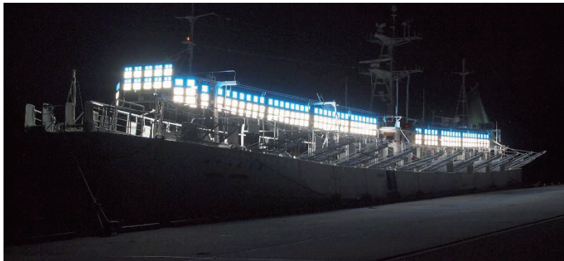
写真 LED 漁灯の点灯試験中の調査船
