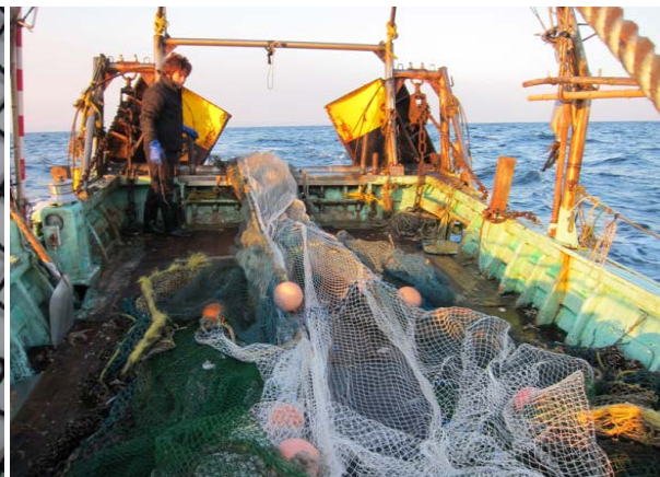
抵抗が小さい網を使った操業試験(白い部分が高強度網系を使用し、網目を拡大した無結節網)
