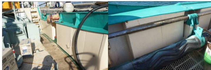
写真3:複板化されたブルワーク(実船)
