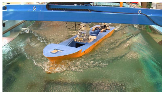
Fig.1 回流水槽での操縦性能試験一例 (184GT さんま棒受網漁船模型, L_{pp}=2.0\text{m} )
