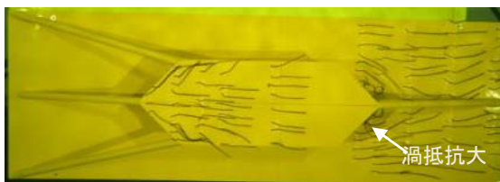
図2 従来型送受波器カバーまわりの流れの様子(タフト法)
