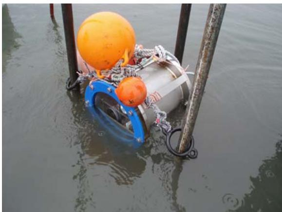
写真-1 間欠駆動式水中ビデオカメラ設置状況
