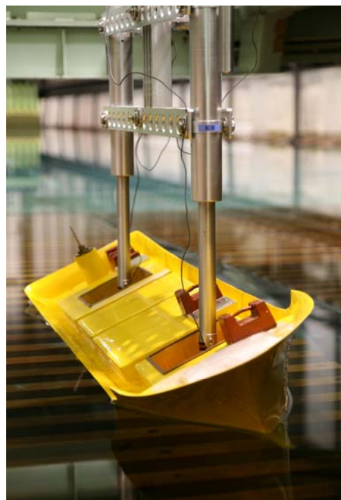
写真: 大傾斜波浪中流体力計測システム
