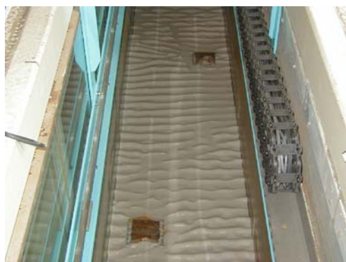
造波水路での底質安定機能模型実験
