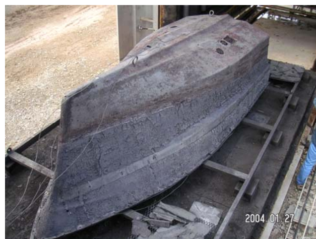
FRP 漁船の炭化処理(左:炭化前、右:炭化後)
