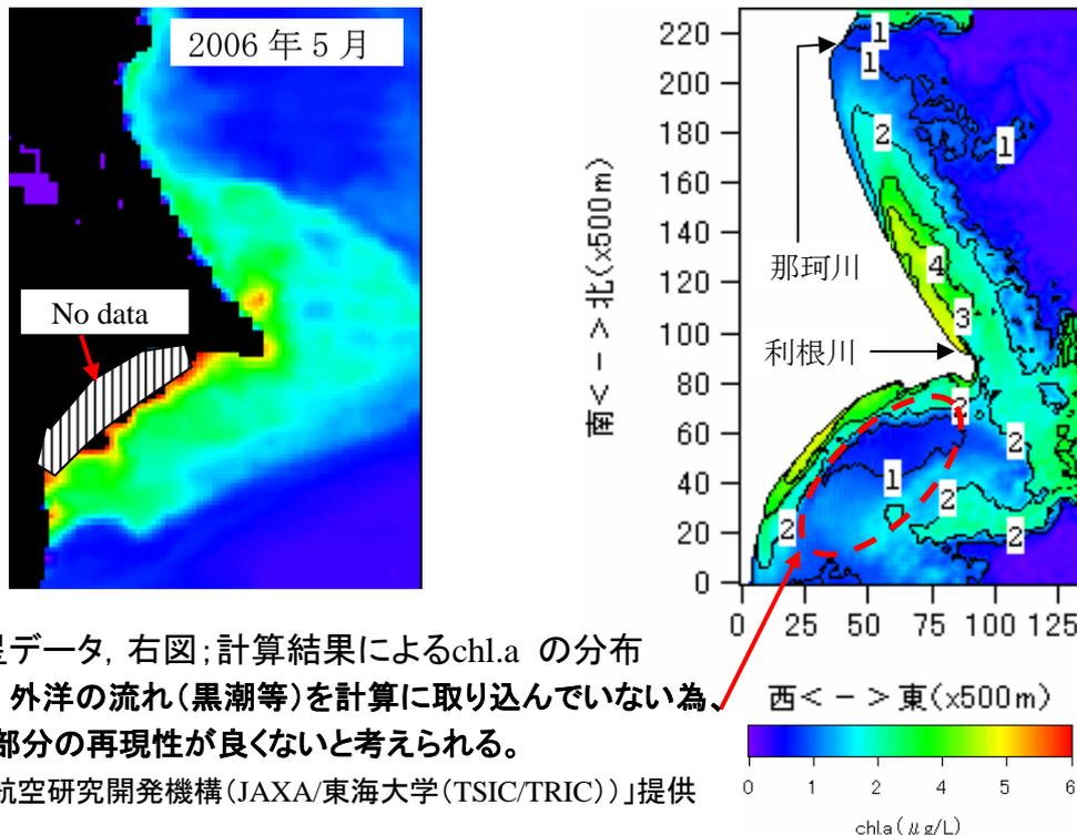
左図;衛星データ, 右図;計算結果によるchl.a の分布
