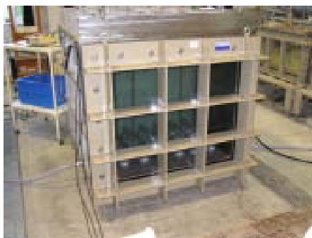
固化処理土の振動水圧耐久性試験
