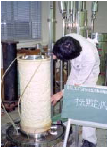
三軸圧縮試験の供試体 （貝殻最大粒径30mm）
