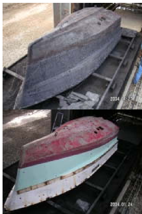
図2 FRP漁船の炭化処理 (下図:炭化前、上図:炭化後)
