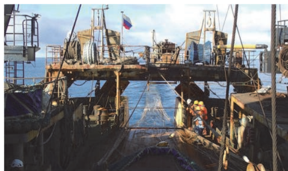
写真 4. トロール網の操業風景, ネットソナーで網の深さや開口面積をモニタリングし, 表層から 30 メートルまでの深さを毎時 4.4 ノット (平均) で 1 時間曳網。
