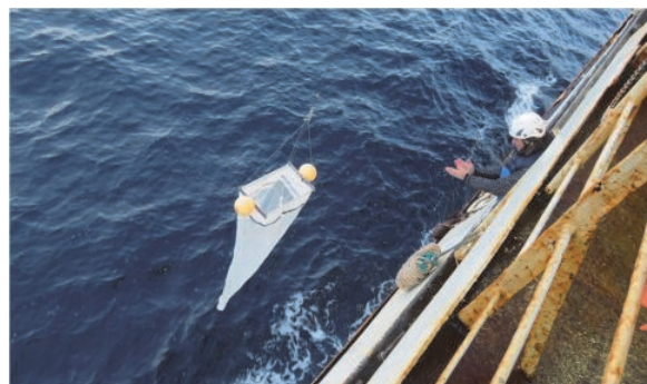
写真 5. 海中に漂うマイクロプラスチックの採集作業
