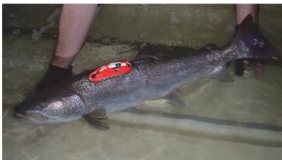
図7. 遊泳深度や経験水温、加速度を記録するデータロガーを装着したイトウ 朱色の物体は浮力体で、他にも電波・超音波発信器とタイマー式切り離し装置が内蔵されている 一定時間経過後に切り離し装置によって機器一式が浮力体とともに水面に浮上する仕組み 回収したロガーからデータを読み出して解析した結果の詳細は Honda et al. (2017)を参照
