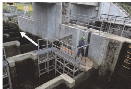
図1. 利根川中流部(埼玉県)の利根大堰魚道に設置された魚カウンター。センサー電極上の水深を維持するためにセンサー電極の downstream 側に角材を設置しています。また、計数精度検証の際に、魚体を識別しやすくするために水路床を白く塗装しています。白色矢印は流下方向を示します。
