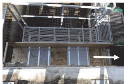
図2. 信濃川宮中取水ダムに設置された魚カウンター。カメラ映像の自動撮影のために電極センサーが二組設置されています。映像撮影に際し、魚体の識別を容易にするために電極の下に塩化ビニル製板がはられています。白色矢印は流下方向を示します。
