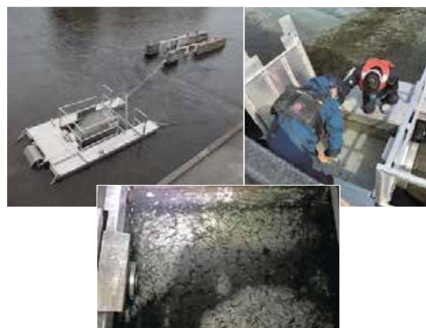
図2. 千歳川に設置したスクリュートラップ(左上)、蓋を開け、イケース内の魚をすくい取る(右上)、トラップで捕獲した約1000尾のサケ稚魚(下)
