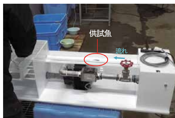
写真2. 瞬発遊泳速度測定装置と測定風景 装置内に魚を投入し、流速を急速に上げ(1秒間に2-3cm/秒)、遊泳できなくなる流速を測定
